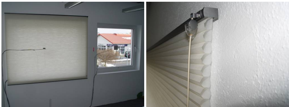
Bild 6: Vor der Fensternische (Versuch 3) \Delta R = 0,13 \text{ m}^2\text{K/W} .
