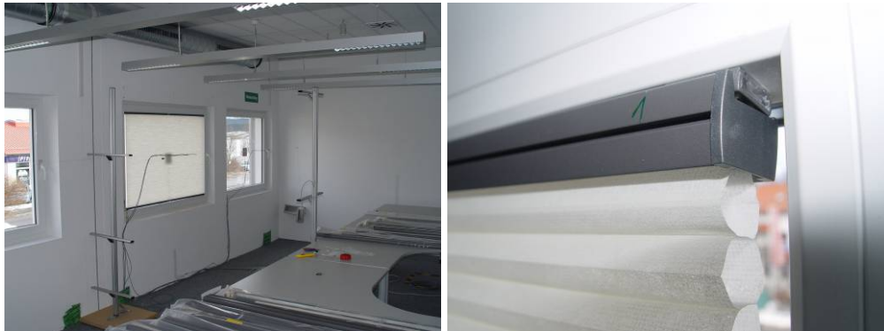
Bild 4: In der Glasleiste (Versuch 1) \Delta R = 0,23 \text{ m}^2\text{K/W} .
