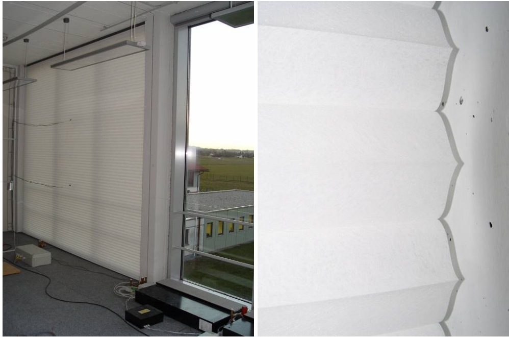
Bild 28: Duette 64 Architella Semi-Opaque (Versuch 25) \Delta R = 0,32 \text{ m}^2\text{K/W} .
