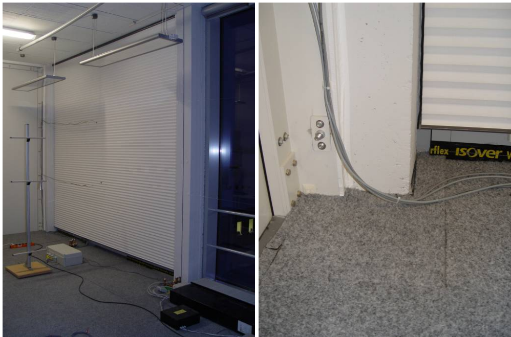
Bild 29: Duette 64 Architella Blackout (Versuch 26) \Delta R = 0,35 \text{ m}^2\text{K/W} .
