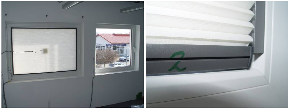
Bild 5: In der Glasleiste mit Seitenführung (Versuch 2) \Delta R = 0,23 \text{ m}^2\text{K/W} .
