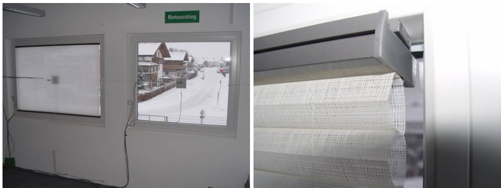
Bild 14: In der Glasleiste (Versuch 11) \Delta R = 0,11 \text{ m}^2\text{K/W} .
