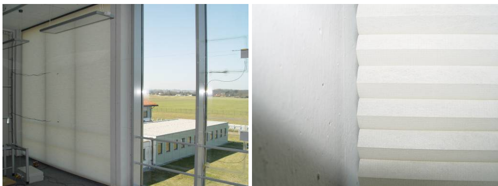
Bild 32: Duette Fixé 25 Duoton (Versuch 29) \Delta R = 0,17 \text{ m}^2\text{K/W} .
