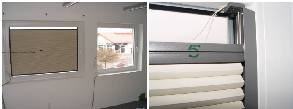
Bild 8: In der Glasleiste mit Seitenführung (Versuch 5) \Delta R = 0,26 \text{ m}^2\text{K/W} .
