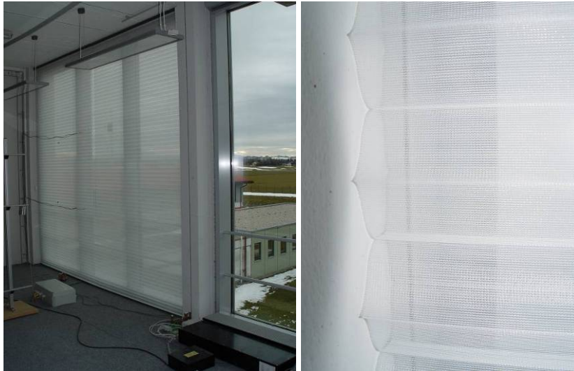
Bild 30: Duette 64 Whisper (Versuch 27) \Delta R = 0,04 \text{ m}^2\text{K/W} .
