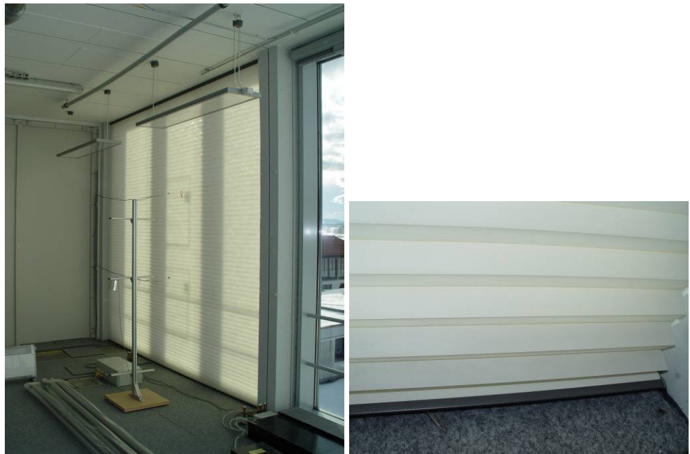
Bild 26: Duette 64 Duoton (Versuch 23) \Delta R = 0,19 \text{ m}^2\text{K/W} .
