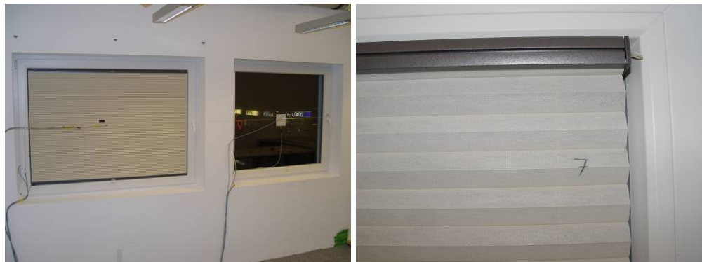
Bild 10: In der Glasleiste (Versuch 7) \Delta R = 0,23 \text{ m}^2\text{K/W} .
