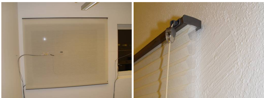
Bild 15: Vor der Fensternische (Versuch 12) \Delta R = 0,08 \text{ m}^2\text{K/W} .
