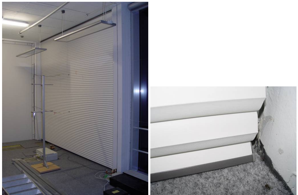
Bild 27: Duette 64 Blackout (Versuch 24) \Delta R = 0,34 \text{ m}^2\text{K/W} .
