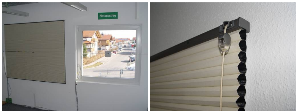
Bild 9: Vor der Fensternische (Versuch 6) \Delta R = 0,38 \text{ m}^2\text{K/W} .
