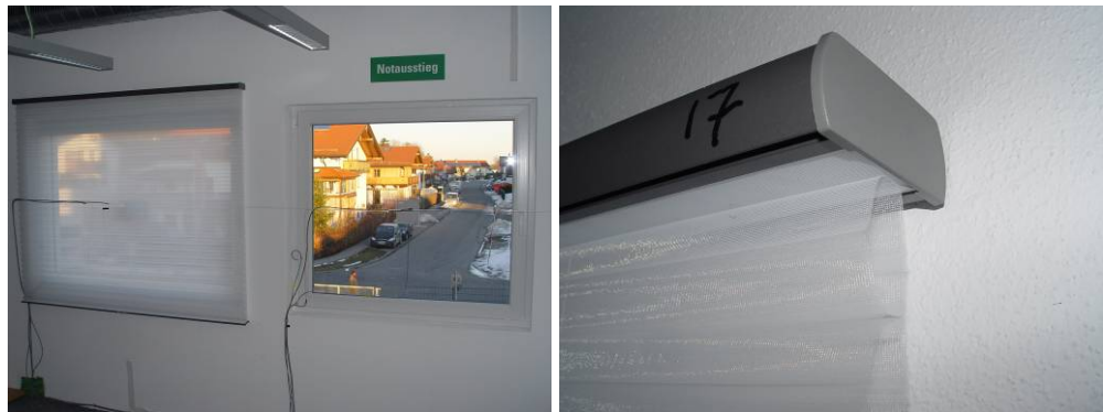
Bild 20: Vor der Fensternische (Versuch 17) \Delta R = 0,05 \text{ m}^2\text{K/W} .
