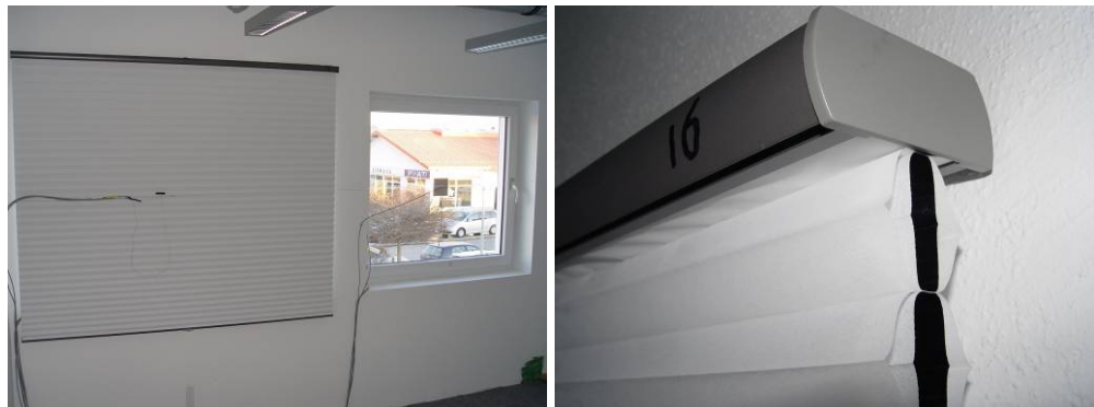
Bild 19: Vor der Fensternische (Versuch 16) \Delta R = 0,11 \text{ m}^2\text{K/W} .
