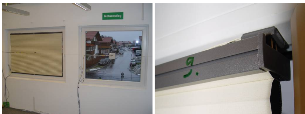
Bild 12: In der Glasleiste (Versuch 9) \Delta R = 0,44 \text{ m}^2\text{K/W} .
