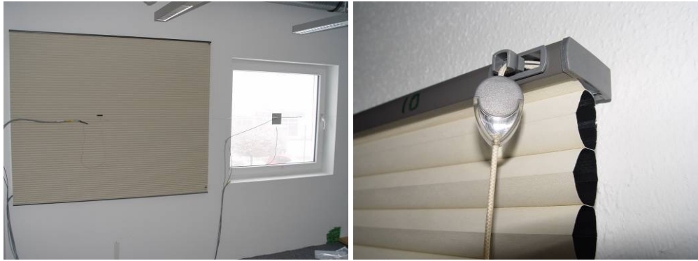
Bild 13: Vor der Fensternische (Versuch 10) \Delta R = 0,17 \text{ m}^2\text{K/W} .
