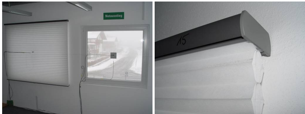
Bild 18: Vor der Fensternische (Versuch 15) \Delta R = 0,12 \text{ m}^2\text{K/W} .
