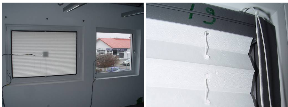
Bild 22: In der Glasleiste mit Seitenführung (Versuch 19) \Delta R = 0,14 \text{ m}^2\text{K/W} .
