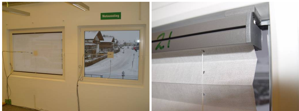
Bild 24: In der Glasleiste (Versuch 21) \Delta R = 0,09 \text{ m}^2\text{K/W} .
