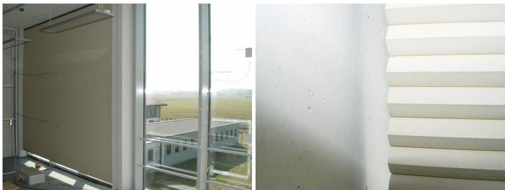
Bild 31: Duette Fixé 25 Blackout (Versuch 28) \Delta R = 0,32 \text{ m}^2\text{K/W} .
