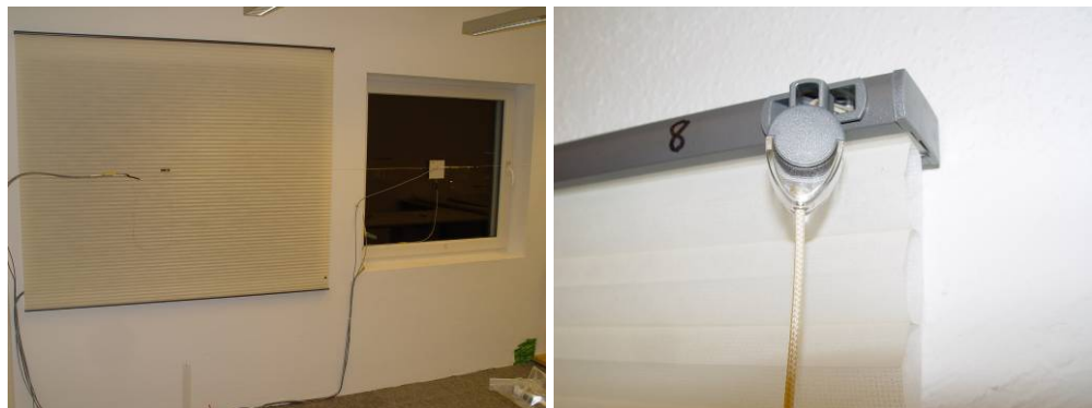
Bild 11: Vor der Fensternische (Versuch 8) \Delta R = 0,11 \text{ m}^2\text{K/W} .
