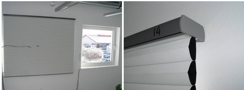
Bild 17: Vor der Fensternische (Versuch 14) \Delta R = 0,11 \text{ m}^2\text{K/W} .
