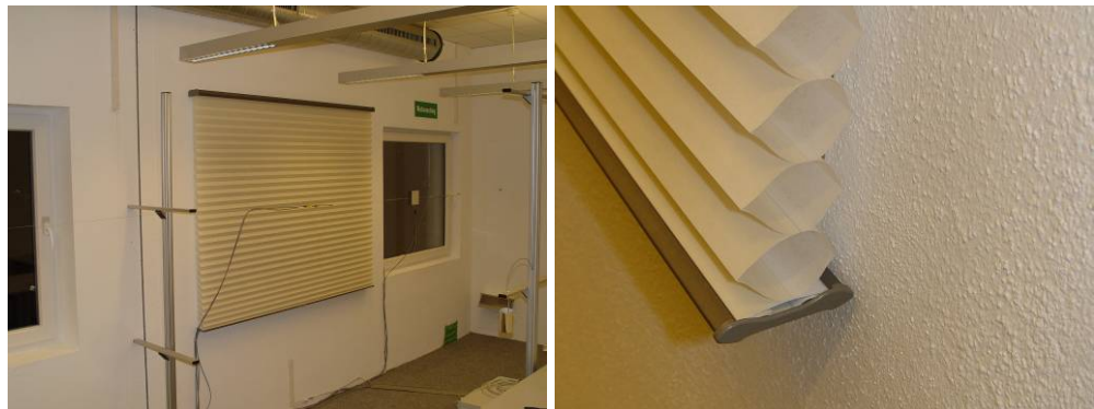
Bild 16: Vor der Fensternische (Versuch 13) \Delta R = 0,10 \text{ m}^2\text{K/W} .
