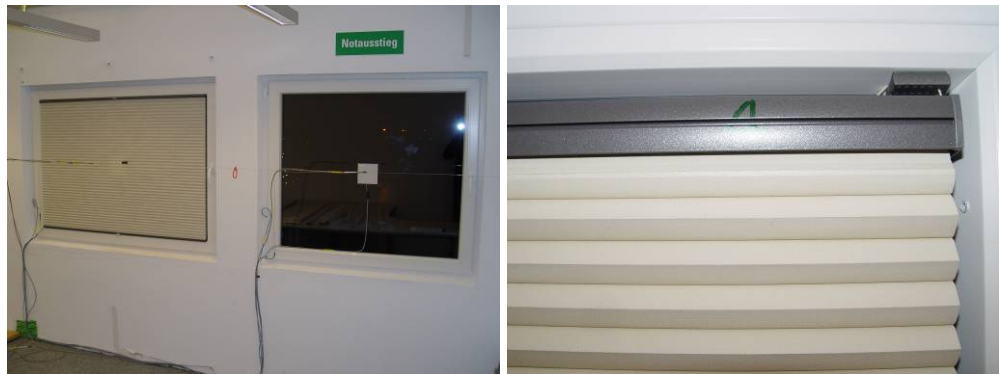
Bild 7: In der Glasleiste (Versuch 4) \Delta R = 0,30 \text{ m}^2\text{K/W} .
